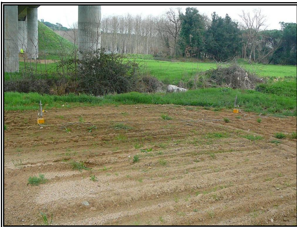
Nº 6.- LVDT's colocados en centro de vano.
