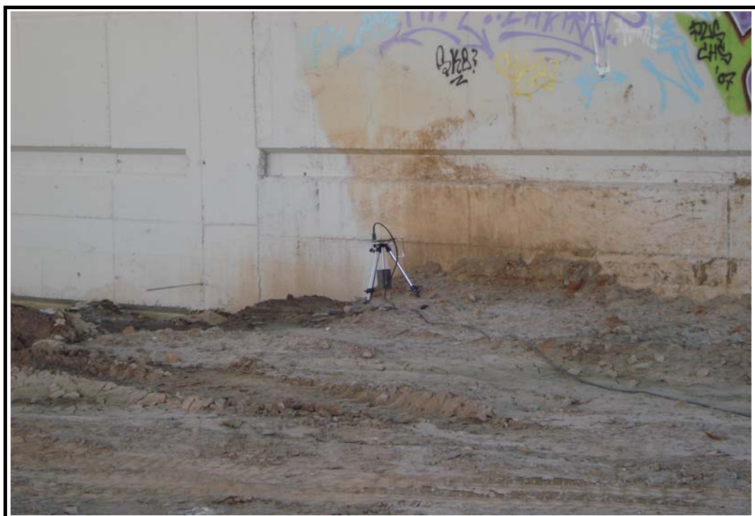
Foto 6: Ménsula para la medida de descenso en apoyo
