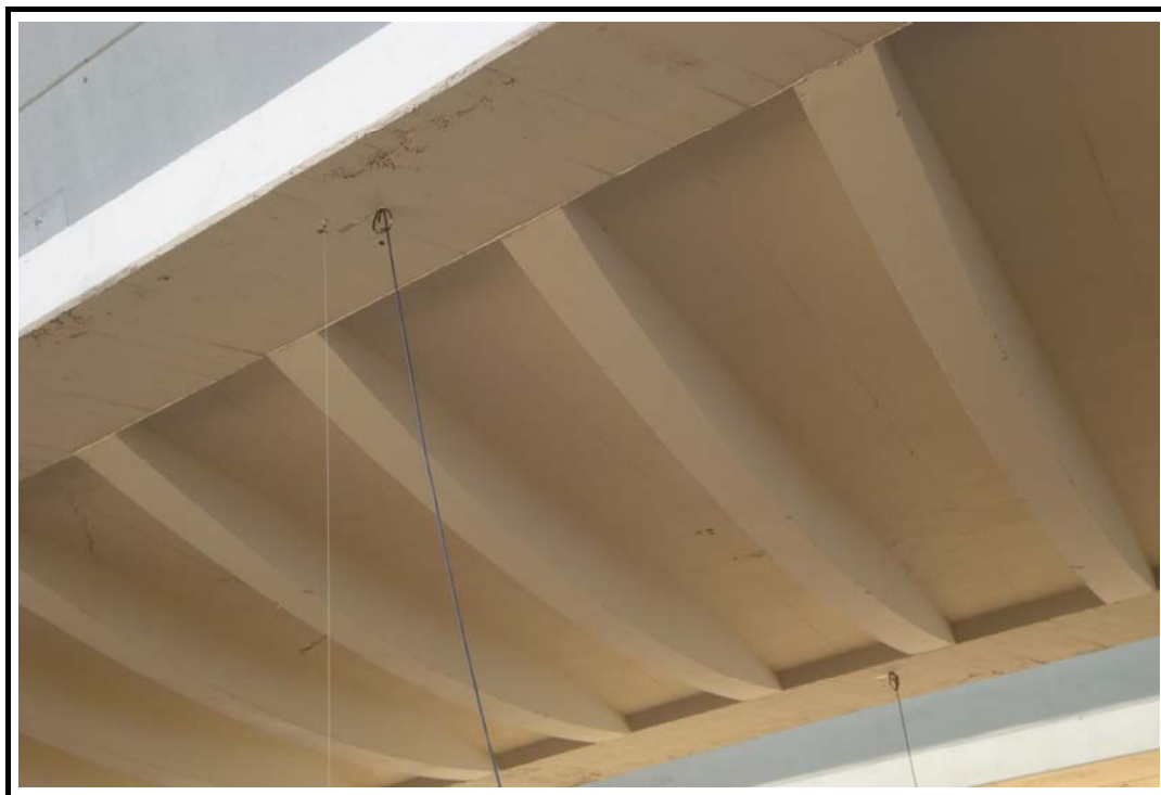
Foto 7: Banda extensiométrica para la medida de deformación en centro de vano
