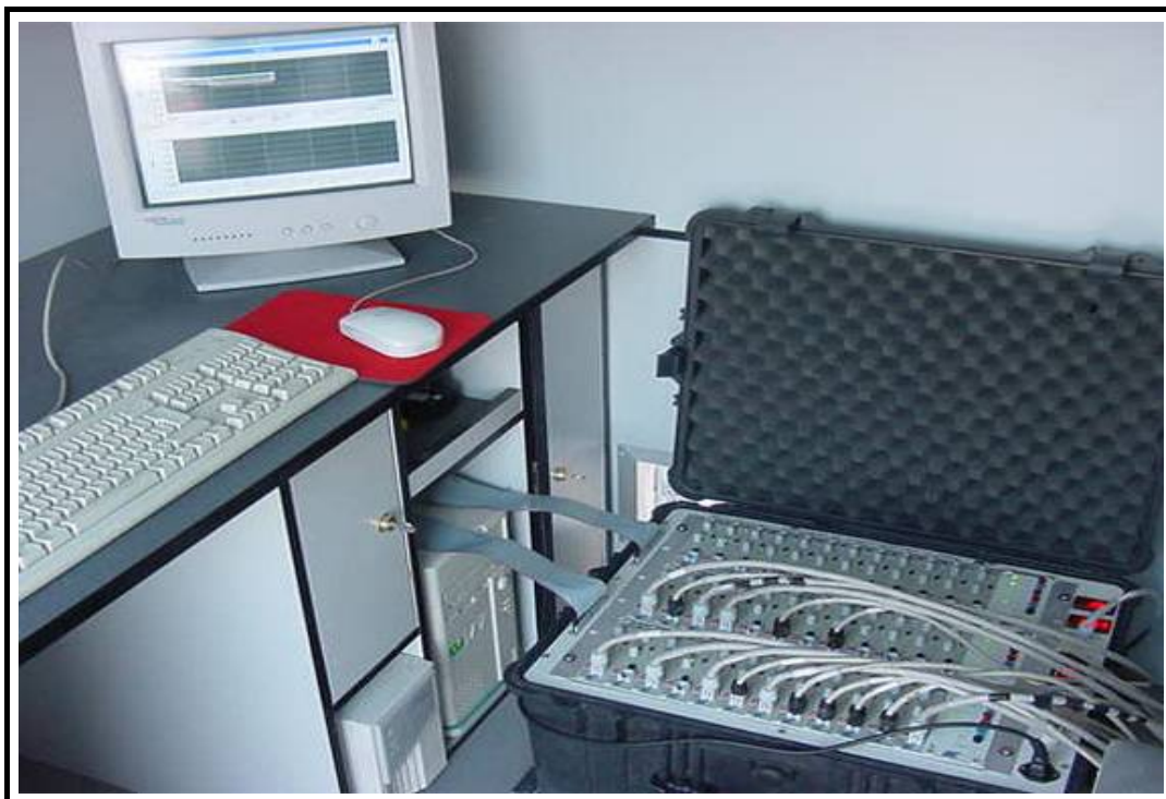
Foto 13: Vista general de acondicionadores de señal y equipo de adquisición.
