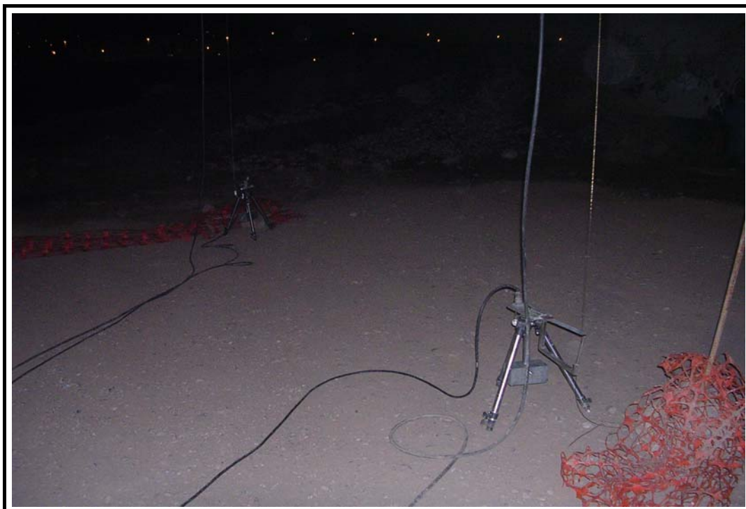
Foto 6: Ménsulas para la medida de flechas en centro de vano.
