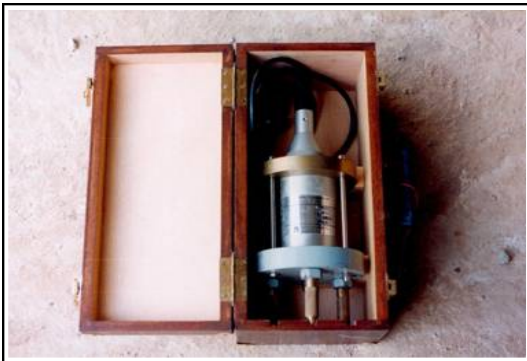
Foto 9: Sismómetro para la medida de velocidades de vibración del tablero.
