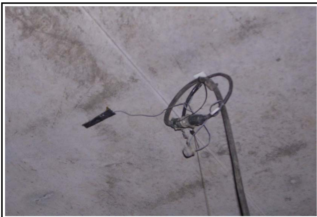
Foto 8: Detalle de la banda extensométrica en centro de vano.
