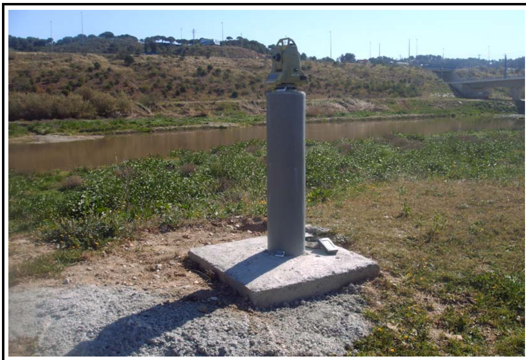
Foto 1: Pilar de observación 1
