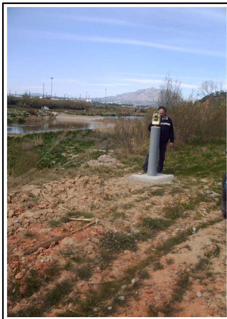
Foto 3: Pilar de observación 3
