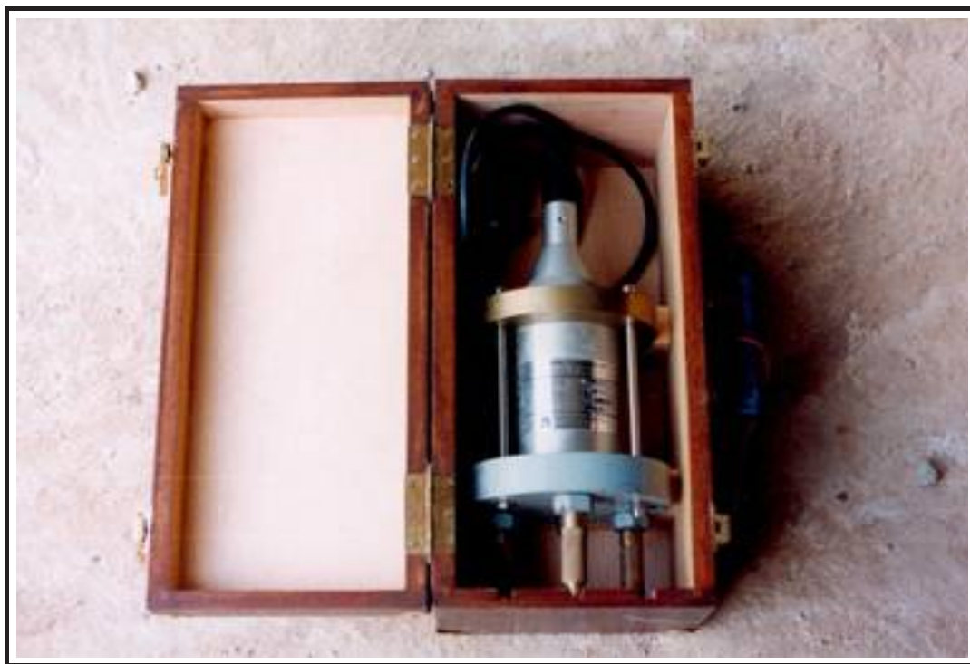
Foto 13: Sismómetro para medida de frecuencia propia de la estructura
