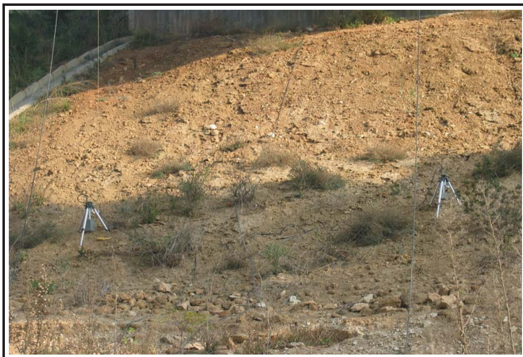
Foto 5: Ménsulas para la medida de flechas en centro de vano
