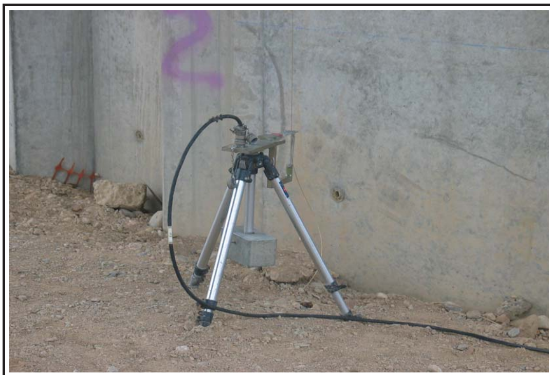
Foto 12: Ménsula para la medida de desplazamientos verticales
