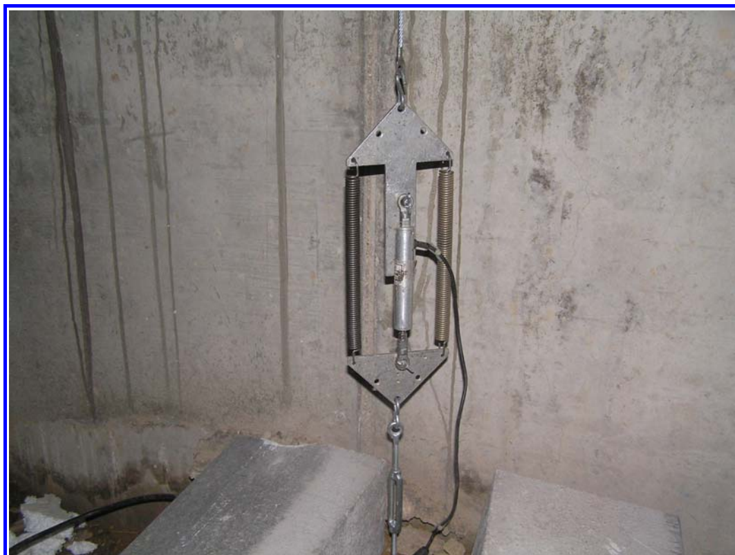
FOTOGRAFÍA N° 6: Detalle transductor desplazamiento en pila o estribo.
