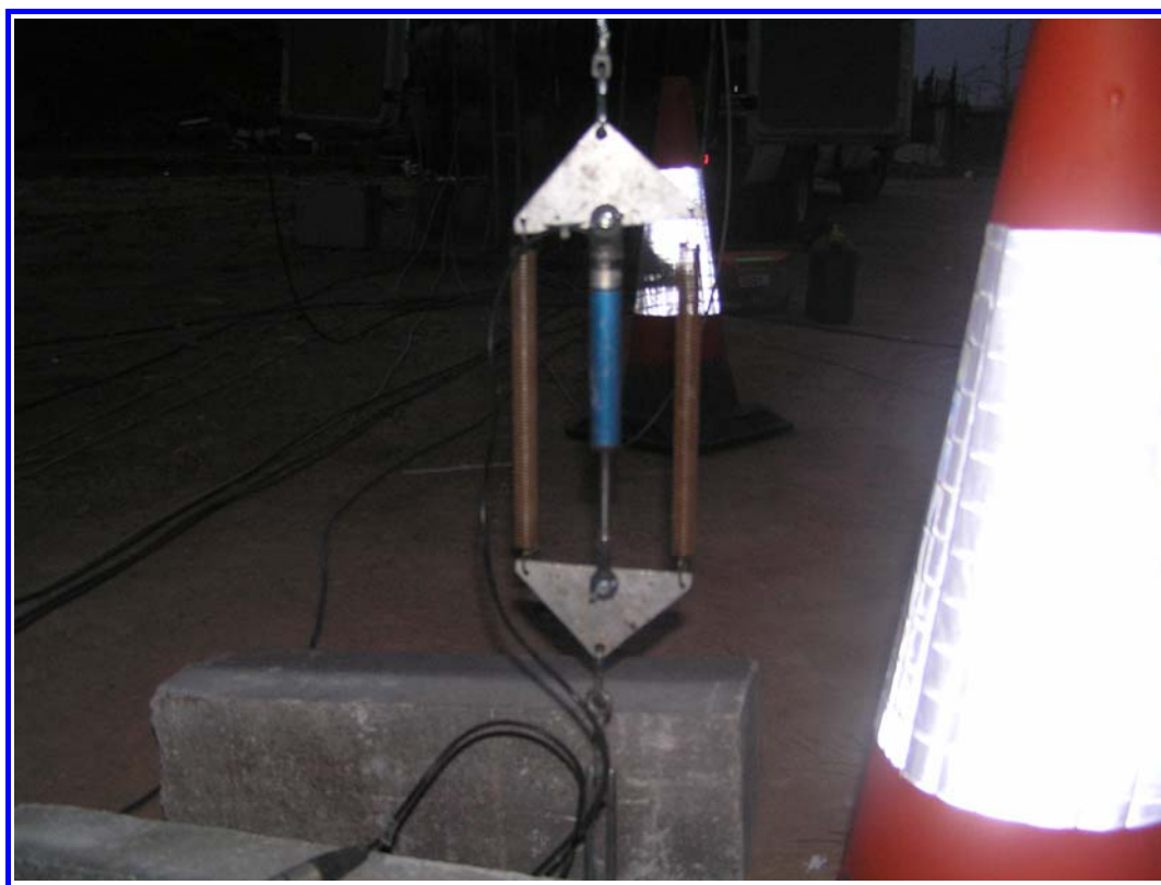
FOTOGRAFÍA N° 5: Detalle transductor desplazamiento en centro de vano.
