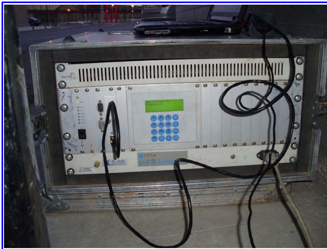
FOTOGRAFÍA Nº 11: Detalle del acondicionador de señal.
