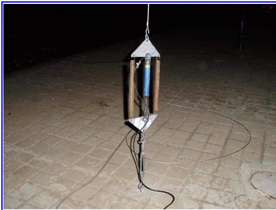
FOTOGRAFÍA N° 7: Detalle de transductor para la medida de flecha.
