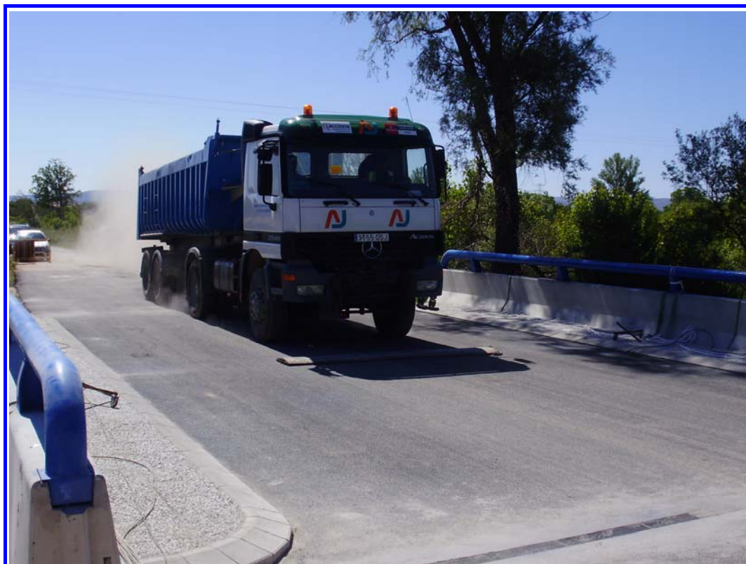
FOTOGRAFÍA N° 12: Detalle tablón normalizado RILEM.
