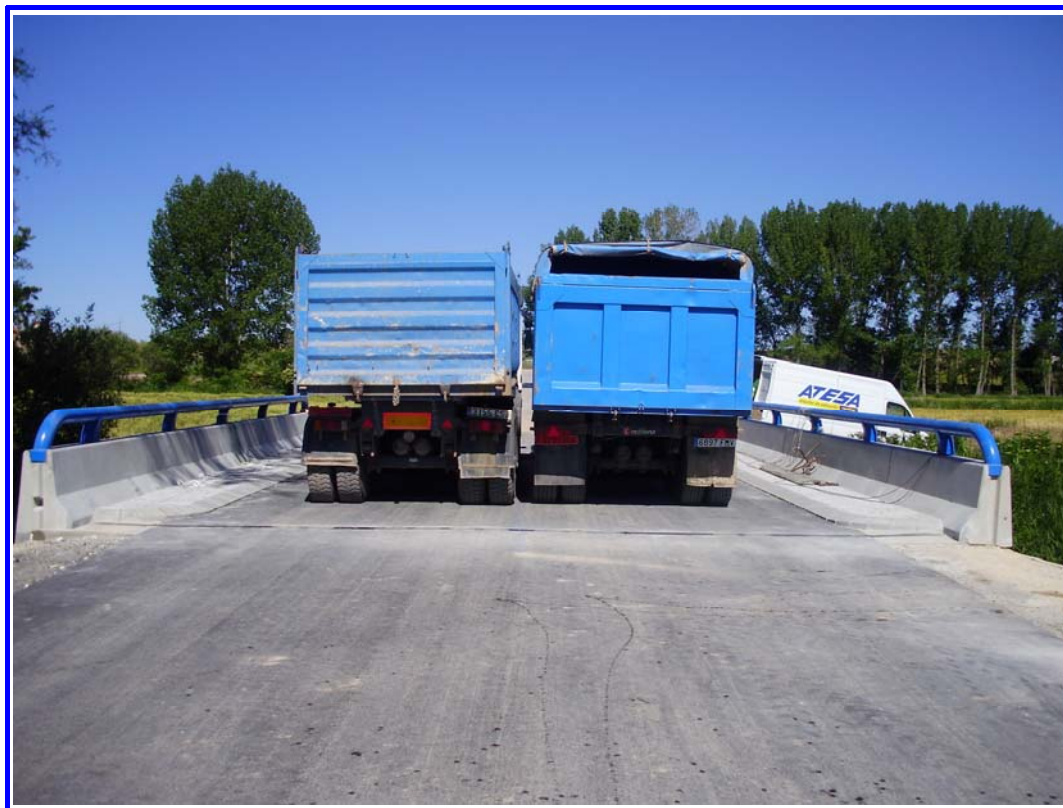
FOTOGRAFÍA N° 11: Prueba estática (vista superior).
