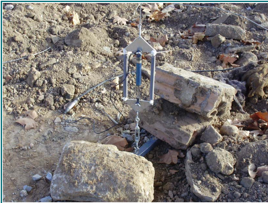
FOTOGRAFÍA N° 5: Detalle transductor desplazamiento en centro de vano.
