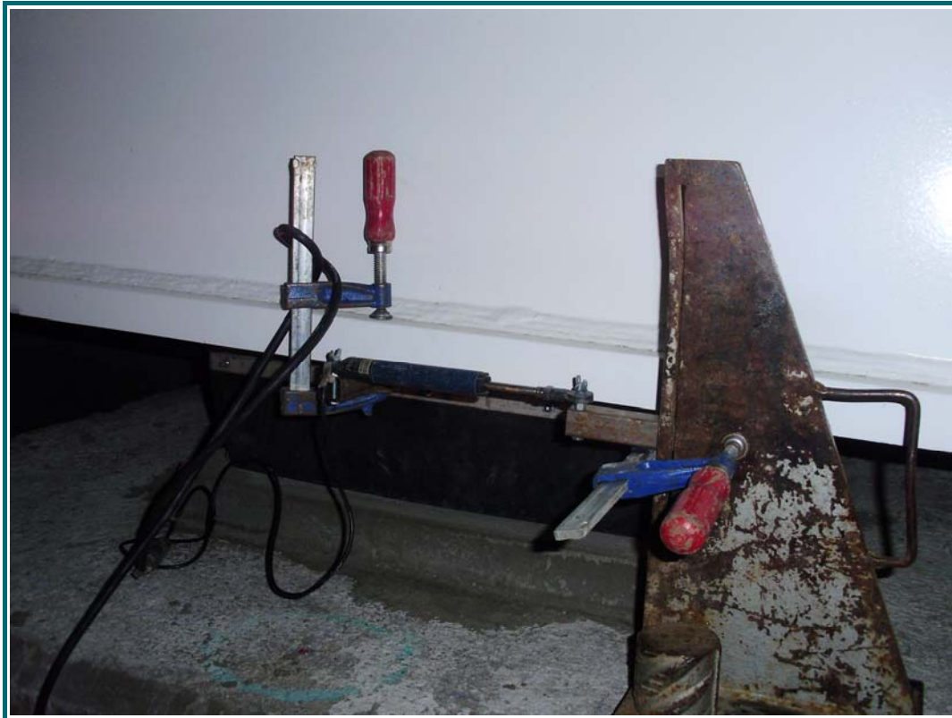
FOTOGRAFÍA N° 5: Detalle transductor en apoyo.
