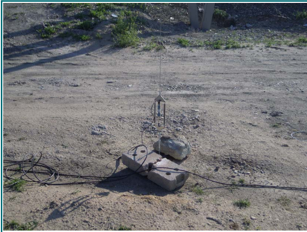
FOTOGRAFÍA N° 5: Transductor desplazamiento en centro de vano.
