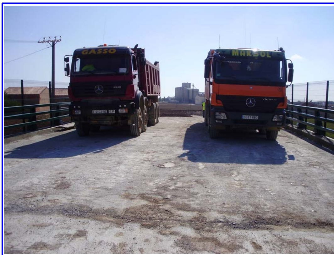
FOTOGRAFÍA Nº 11: Prueba estática (vista superior).
