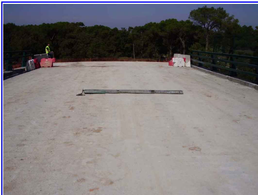
FOTOGRAFÍA Nº 12: Detalle tablón normalizado RILEM.
