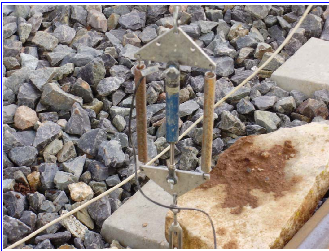
FOTOGRAFÍA N° 5: Detalle transductor desplazamiento en centro de vano.
