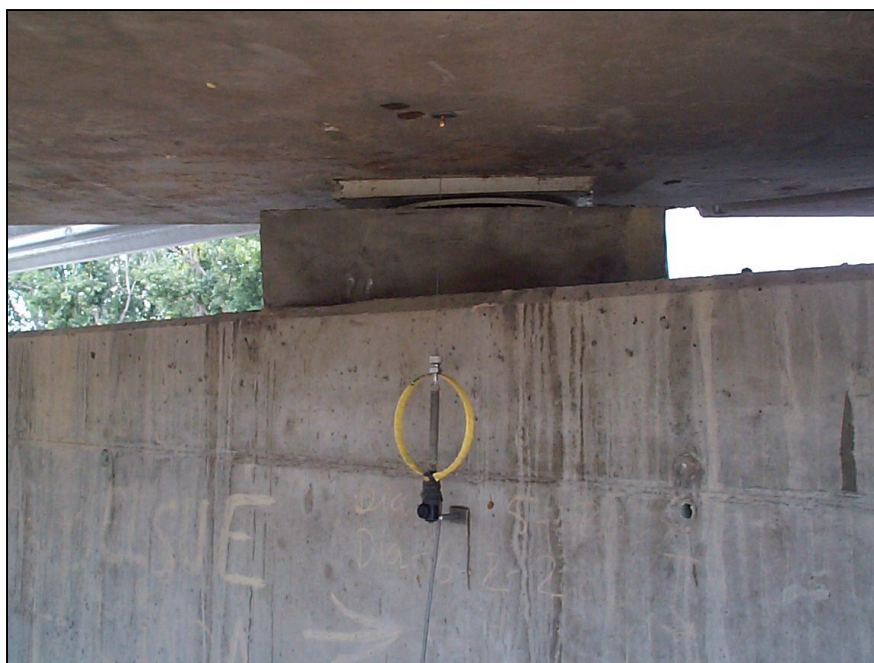
Nº 3.- Instrumentación mediante aros extensométricos de los apoyos en el vano 1.
