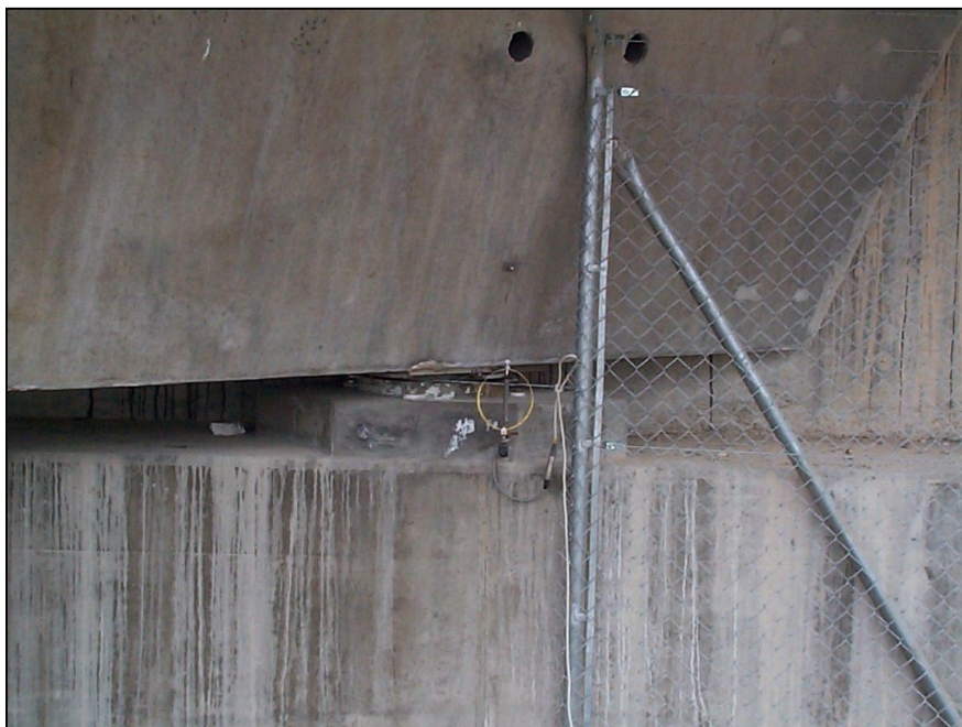
Nº 3.- Instrumentación mediante aros extensométricos de los apoyos en el vano 1.
