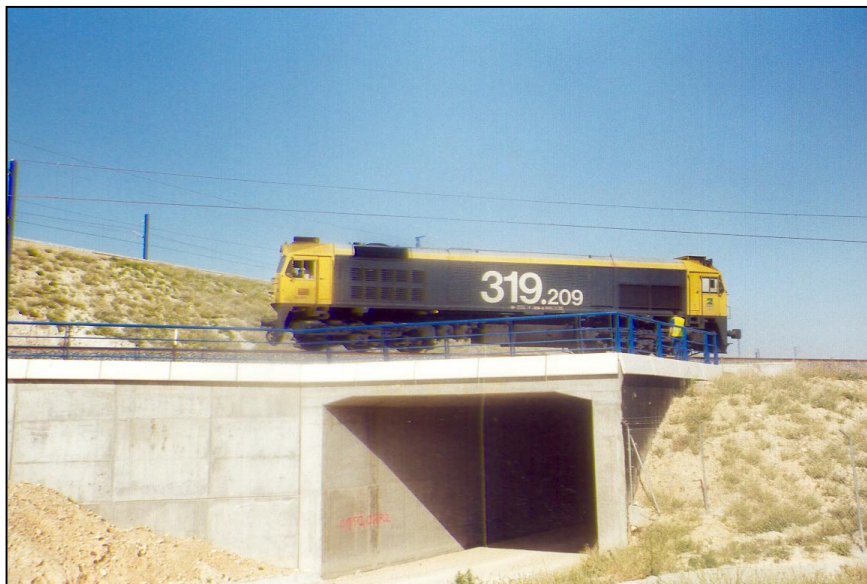
Nº 5.- Realización de la prueba dinámica a máxima velocidad.
