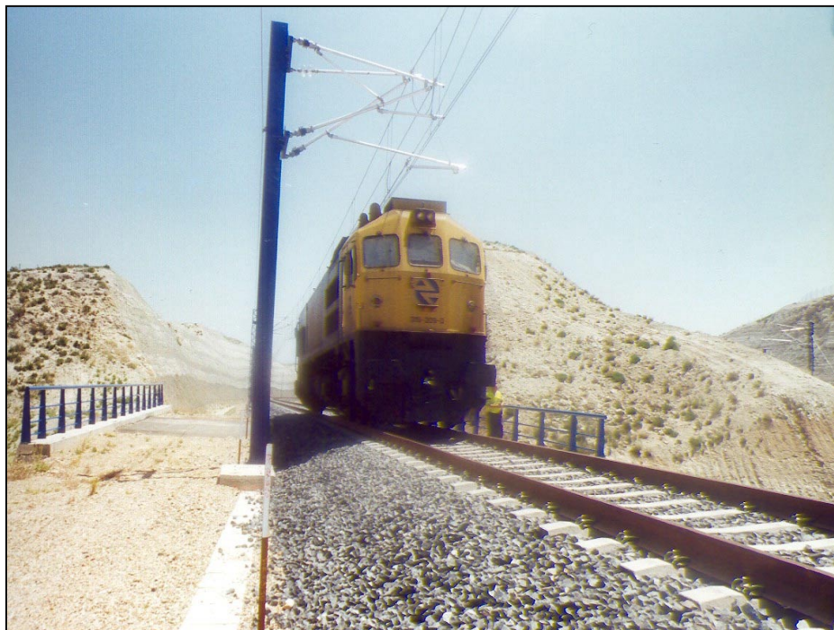
Nº 5.- Realización de las pruebas dinámicas a 30 Km/h.
