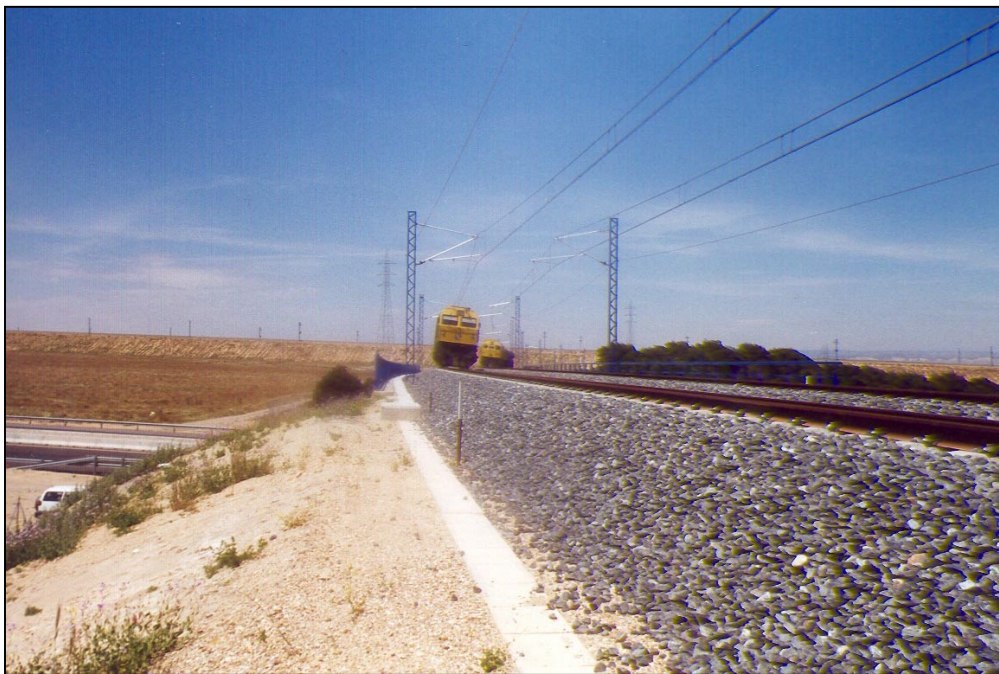
Nº 9.- Prueba dinámica a 5 km/h
