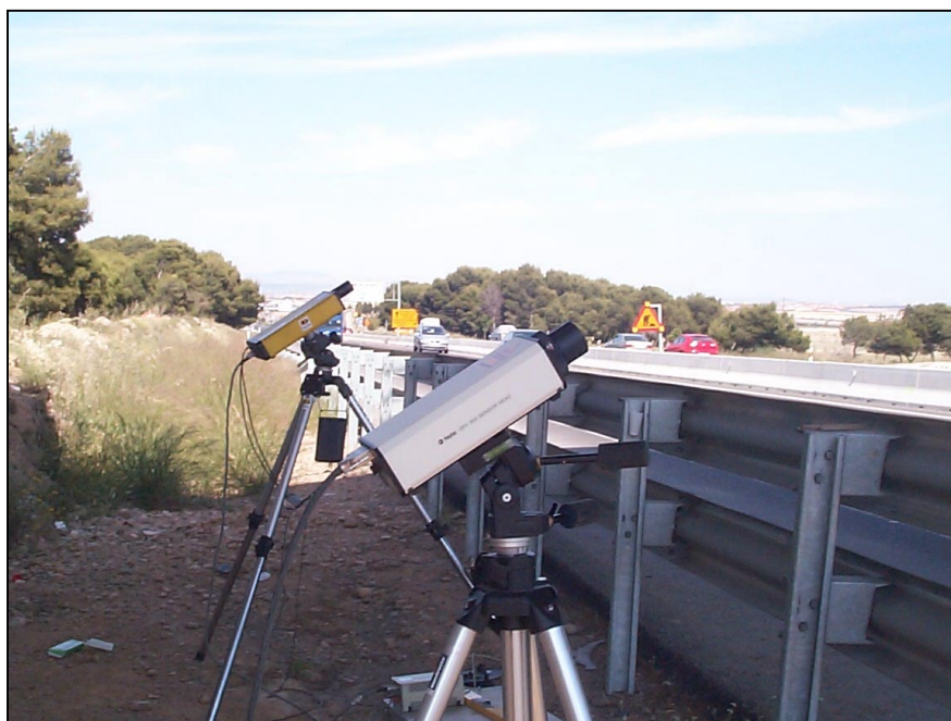
Nº 1.- Medición mediante láser en vano 2
