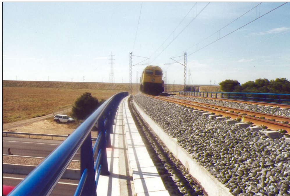
Nº 11.- Prueba dinámica a máxima velocidad
