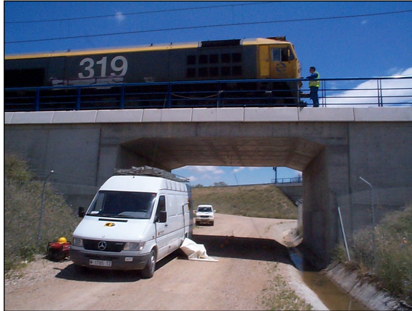
Nº 2.- Realización de las pruebas estáticas
