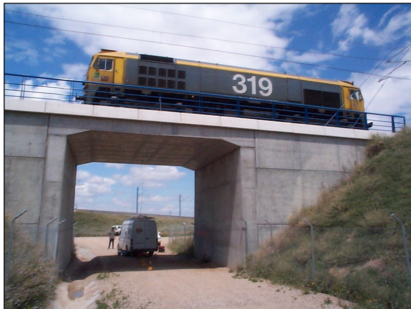
Nº 3.- Realización de las pruebas dinámicas lentas.
