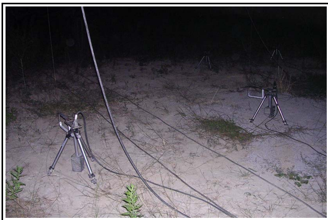
Foto 2: Ménsulas para la medida de flechas en centro de vano
