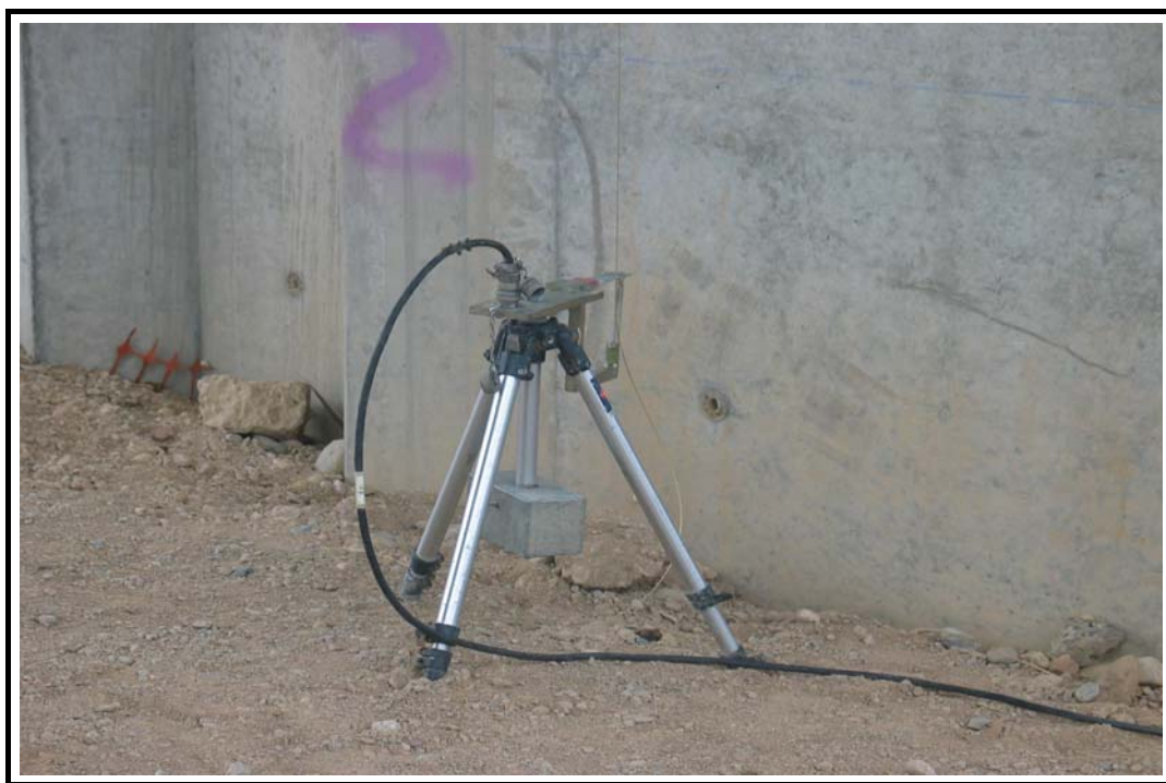
Foto 5: Ménsula para la medida de desplazamientos verticales
