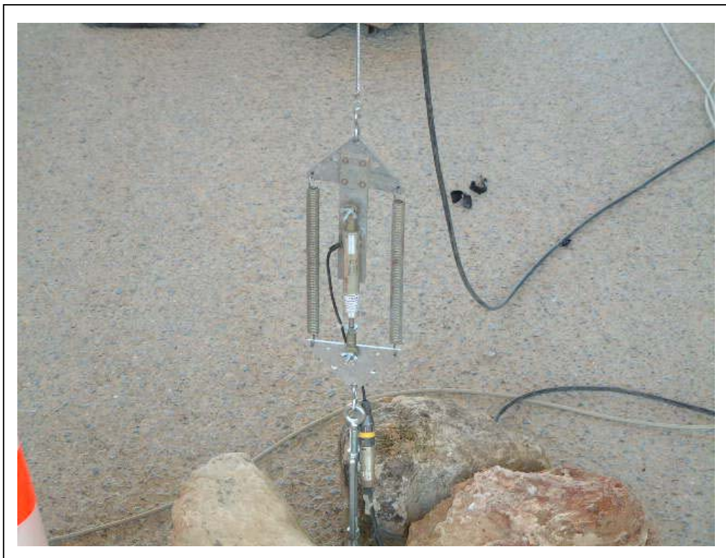
FOTOGRAFÍA 4: Transductor de desplazamiento
