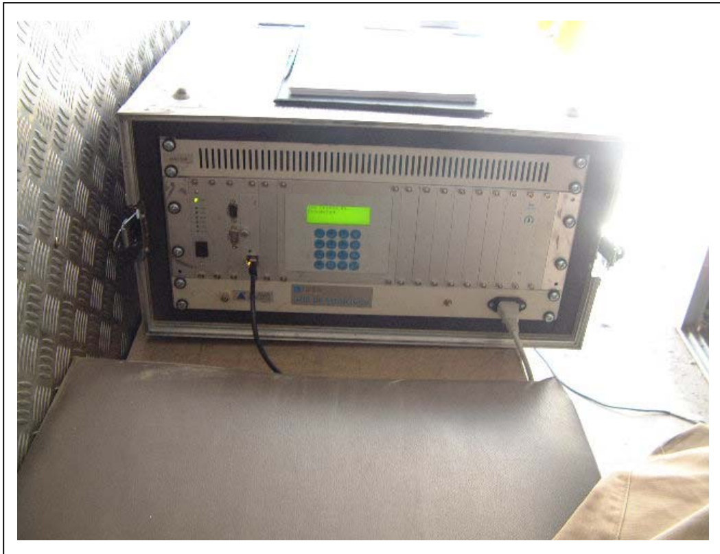
FOTOGRAFÍA 3: Equipos de adquisición de datos
