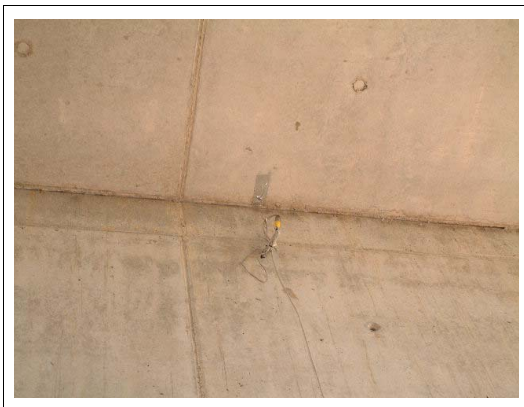
FOTOGRAFÍA 8: Detalle banda extensométrica en empotramiento
