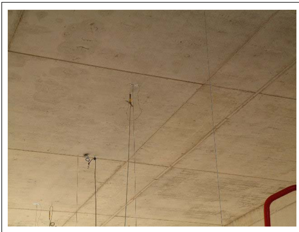
FOTOGRAFÍA 7: Detalle bandas extensométricas y flechas
