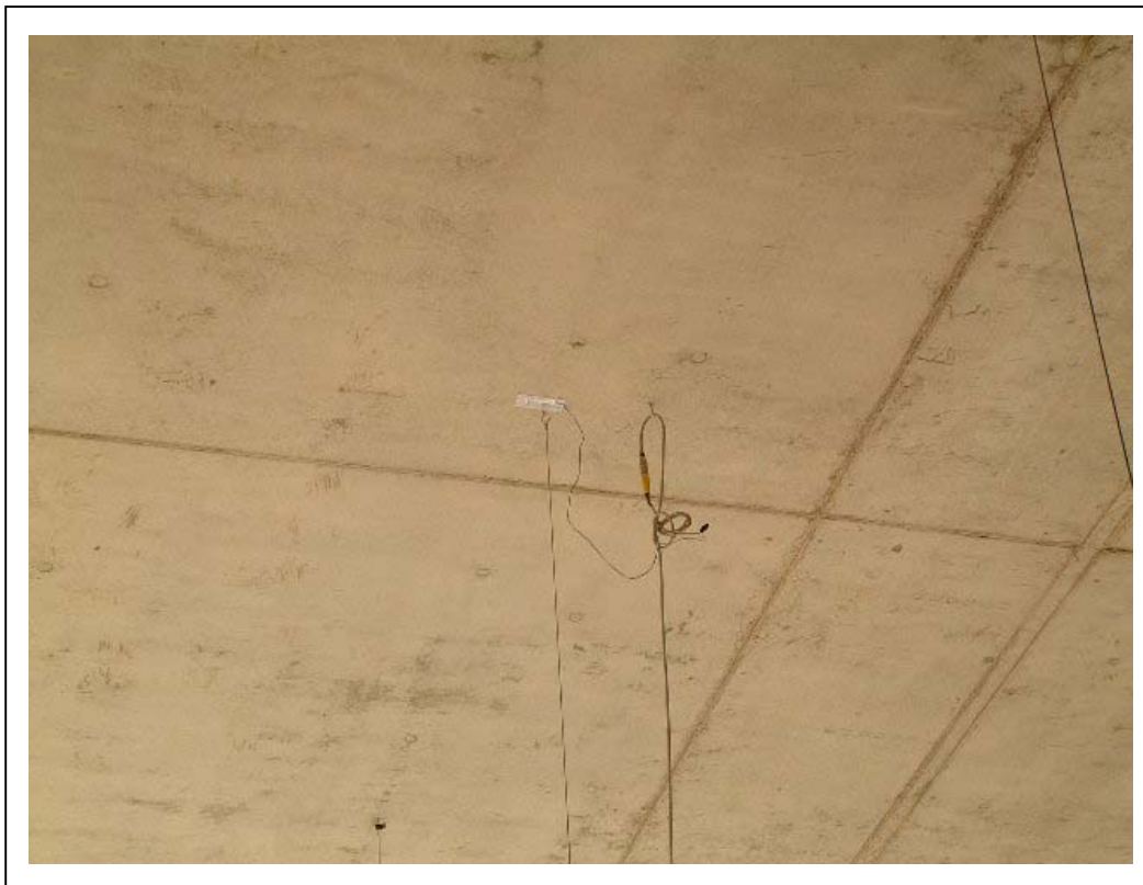
FOTOGRAFÍA 9: Detalle punto de instrumentación L/2
