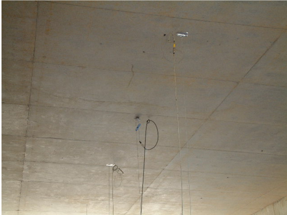
Fotografía 7: Instrumentación a L/2
