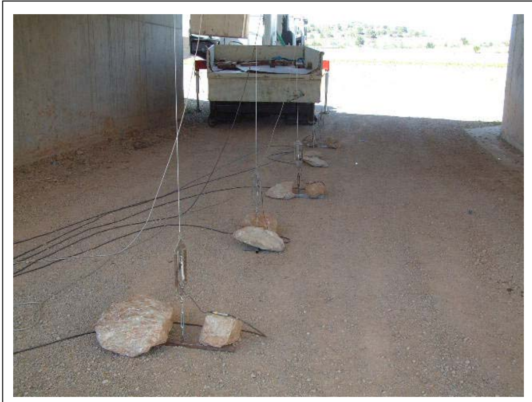
FOTOGRAFÍA 5: Transductores medida de flechas
