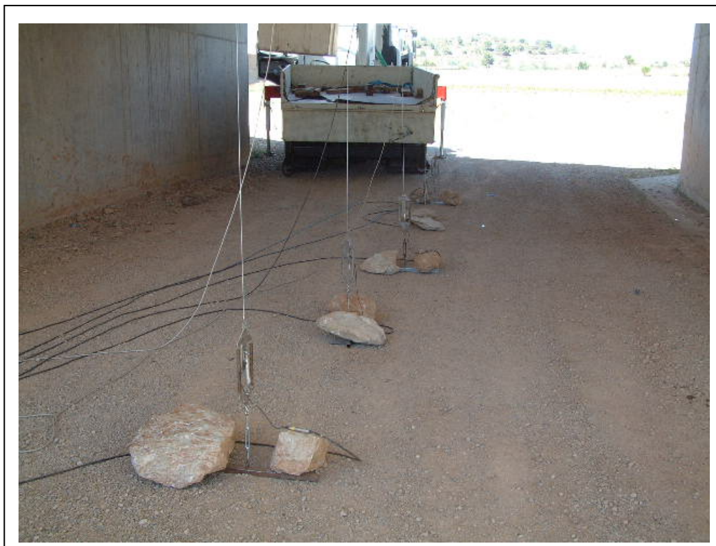
FOTOGRAFÍA 5: Transductores medida de flechas
