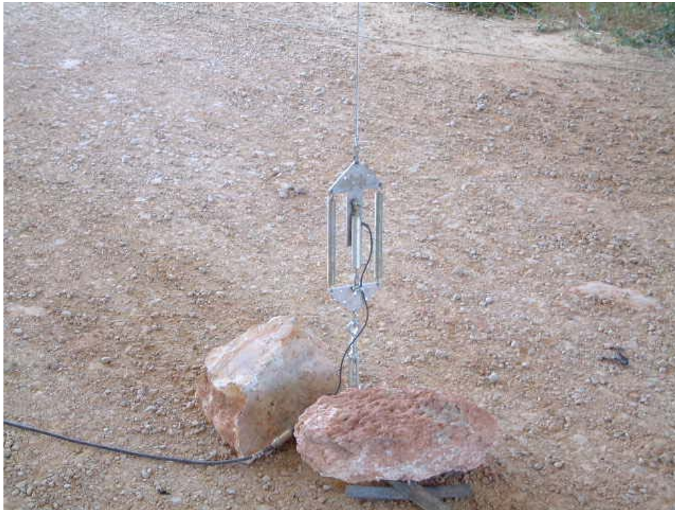
FOTOGRAFÍA 5: Transductores medida flecha
