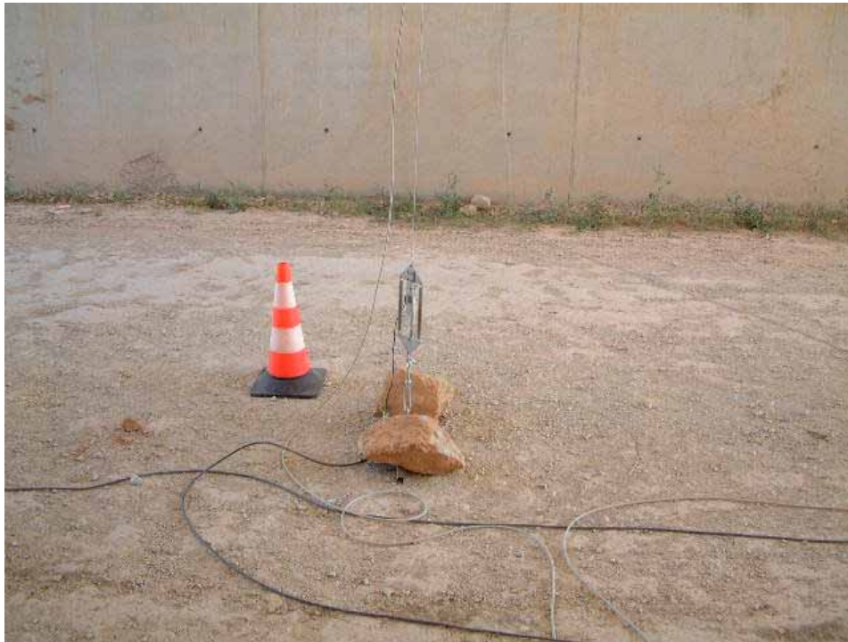
FOTOGRAFÍA 5: Transductores medida flecha
