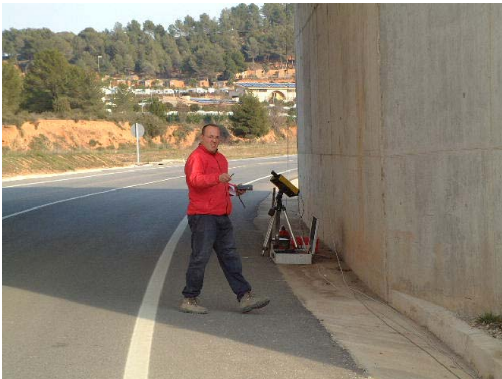
FOTOGRAFÍA 4: Dispositivo láser para la medida flecha
