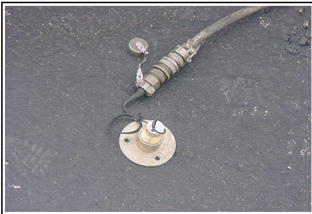
Foto 9: Acelerómetro para medida de frecuencia de la estructura
