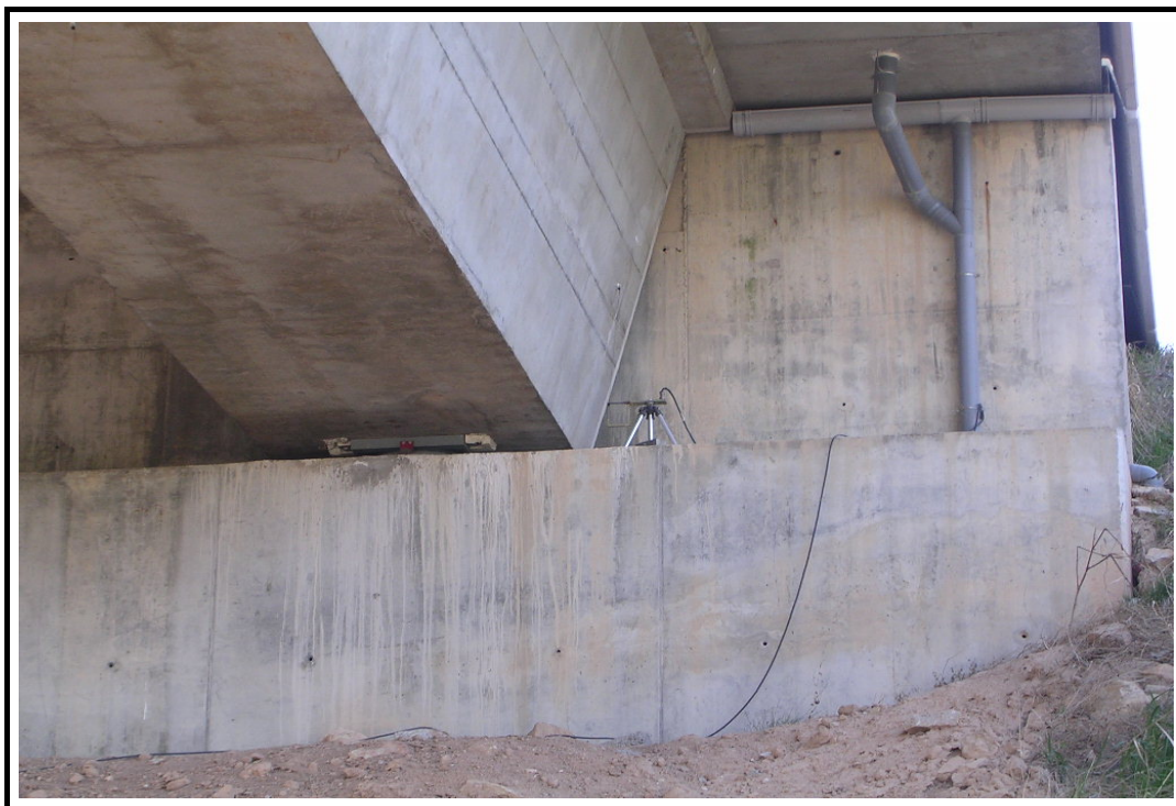
Foto 7: Ménsula para medida de descenso de apoyo
