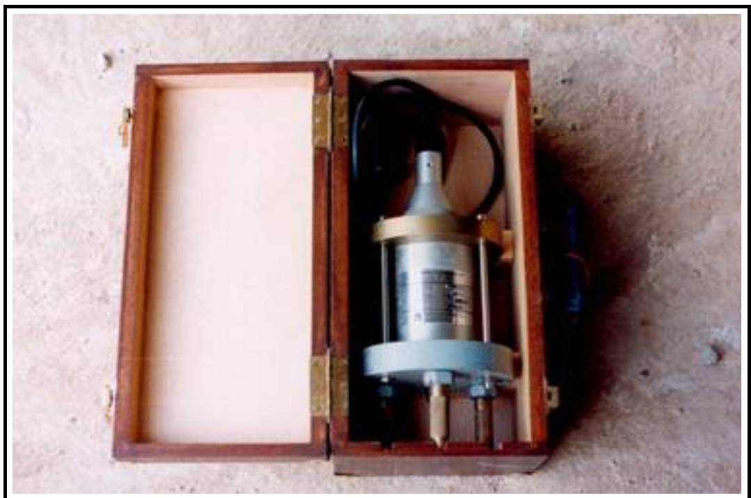
Foto 8: Sismómetro para medida de frecuencia propia de la estructura
