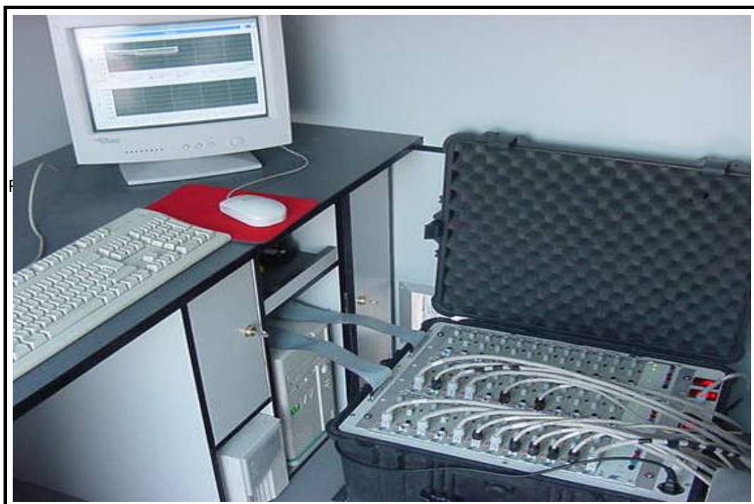
Foto 3: Vista general de acondicionadores de señal y equipo de adquisición
