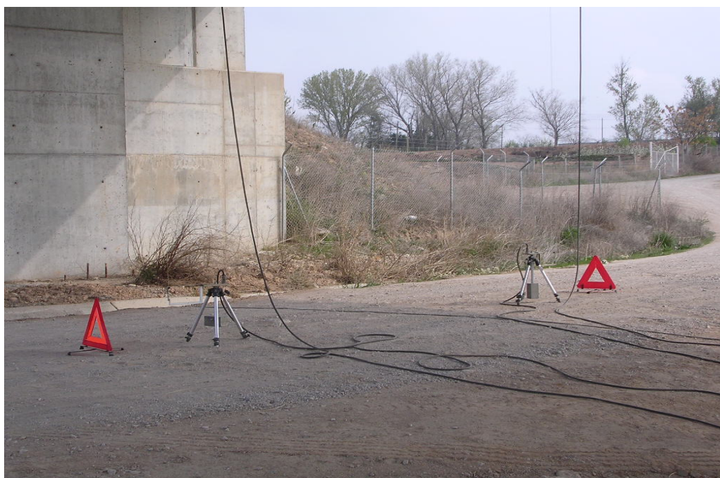
Foto 9: Ménsulas para la medida de flechas en centro de vano
