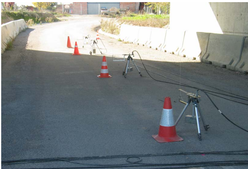
Foto 10: Ménsulas para la medida de flechas en centro de vano
