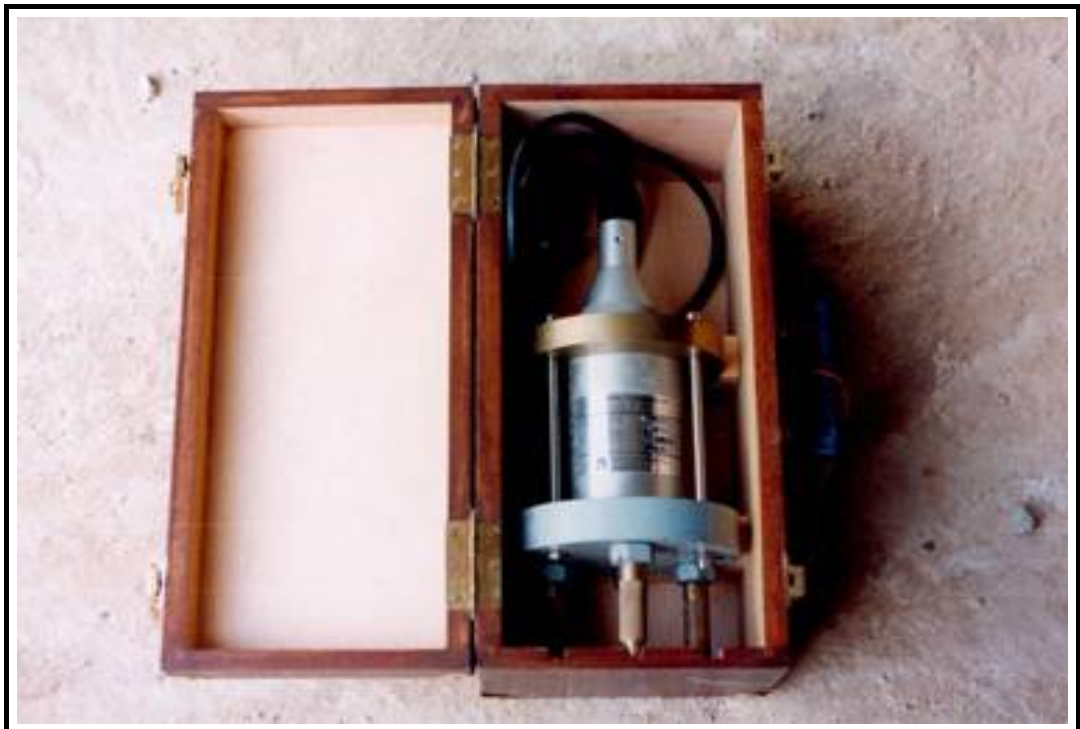
Foto 6: Sismómetro para medida de frecuencia propia de la estructura
