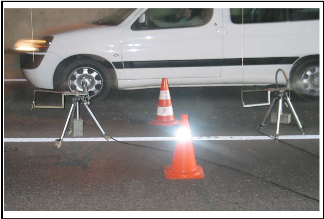
Foto 5: Línea de ménsulas para medida de flechas en centro de vano
