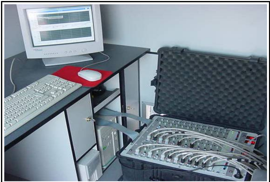
Foto 8: Vista general de acondicionadores de señal y equipo de adquisición
