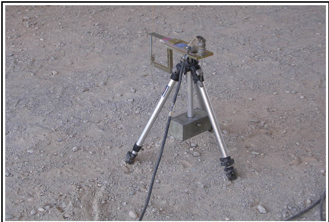
Foto 6: Ménsula para la medida de desplazamientos verticales
