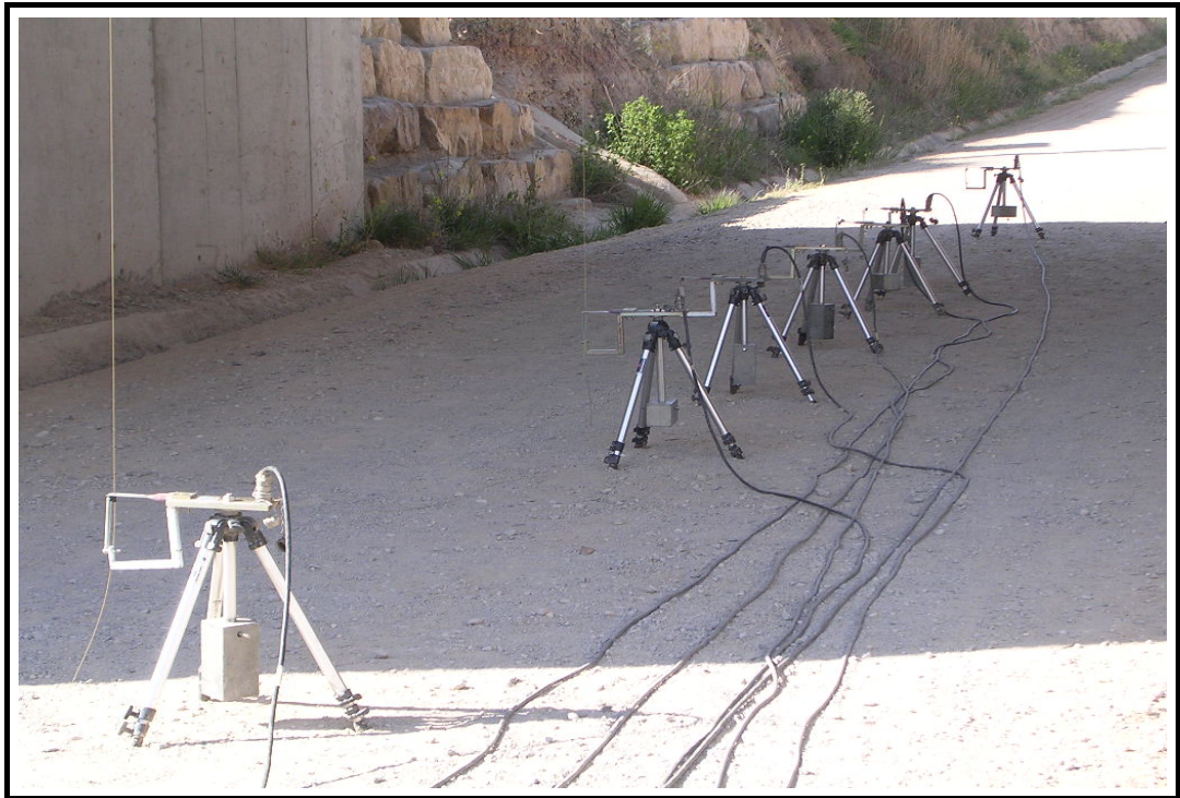
Foto 3: Línea de ménsulas para la medida de flecha en centro de vano
