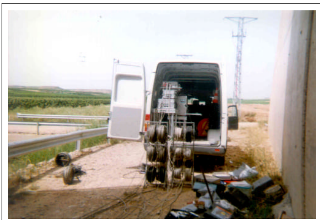
FOTOGRAFÍA 7: Tren de cargas sobre la estructura
