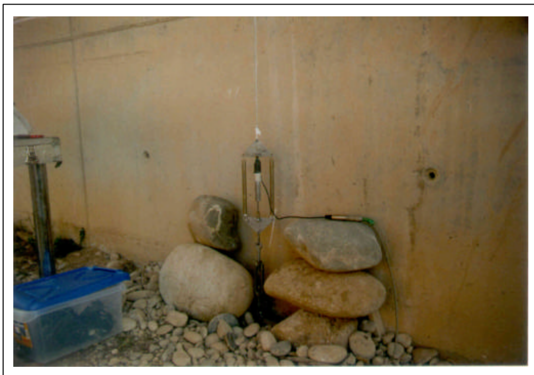
FOTOGRAFÍA 7: Detalle de transductor de desplazamiento en apoyos
