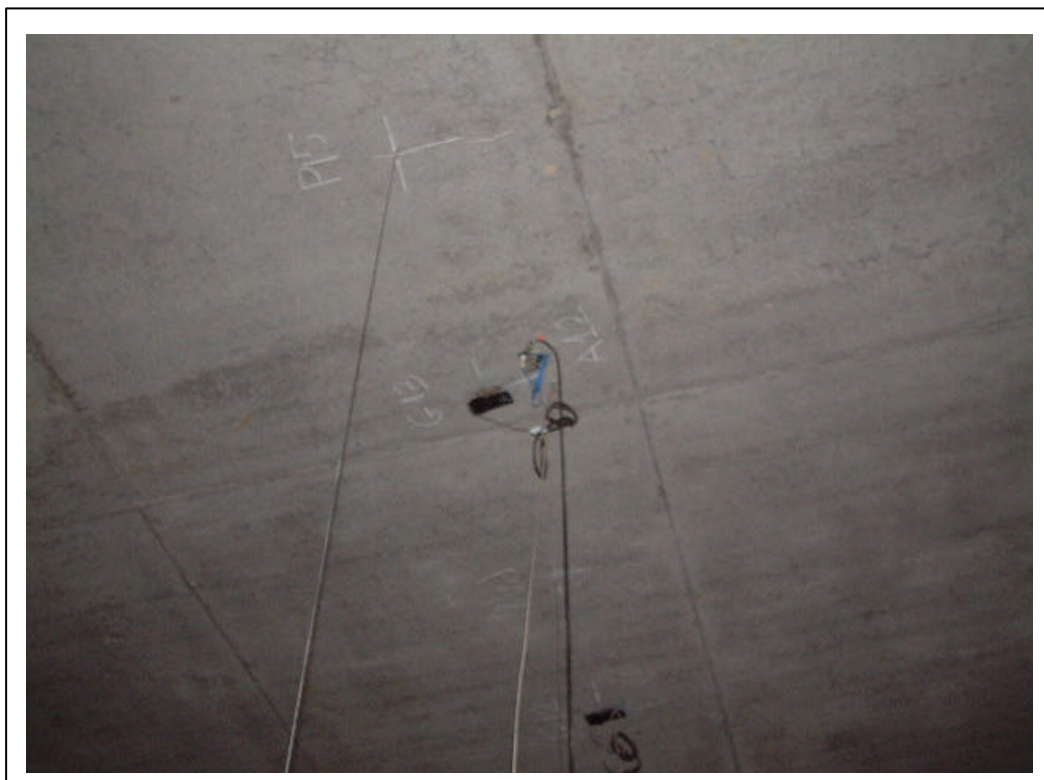
FOTOGRAFÍA 9: Detalle de galga extensométrica, transductor de desplazamiento y acelerómetro
