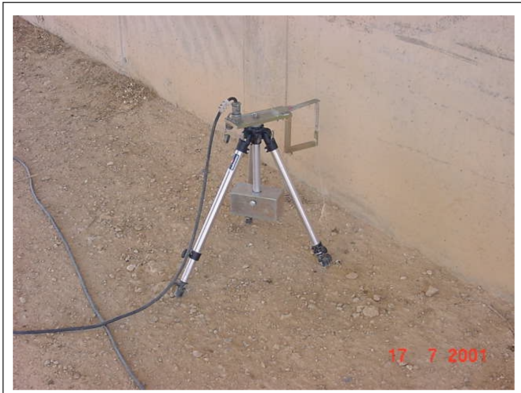
FOTOGRAFÍA 7: Transductor en zona de apoyos
