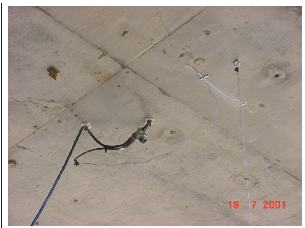
FOTOGRAFÍA 14: Transductor para medida de flechas
