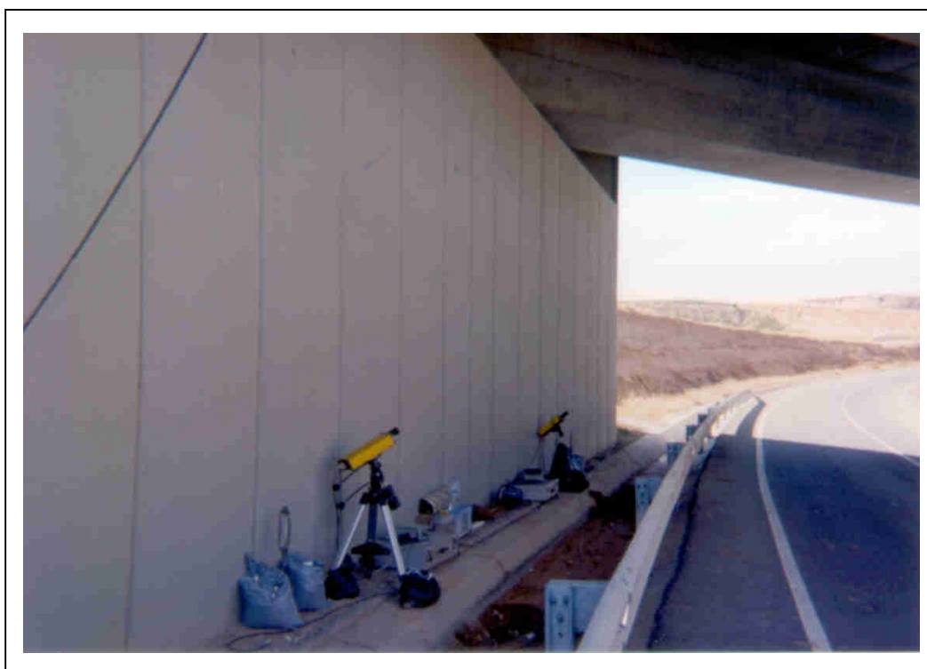
FOTOGRAFÍA 6: Equipos láser de medida
