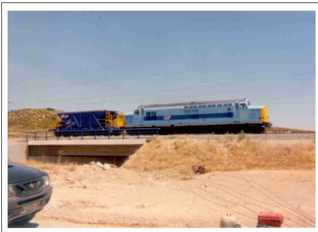
FOTOGRAFÍA 9: Posición de carga estática
