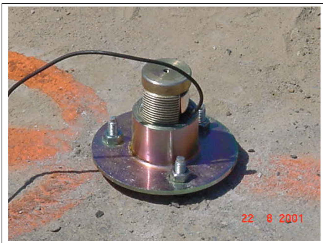
FOTOGRAFÍA 11: Detalle de acelerómetro
