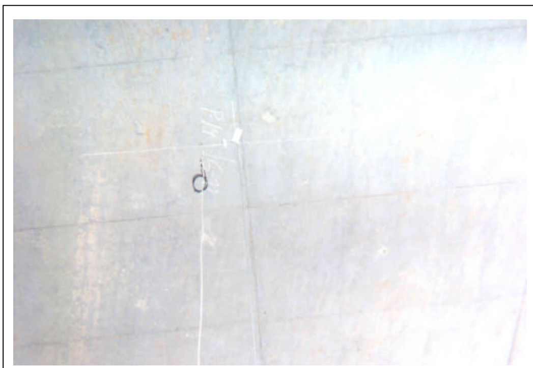
FOTOGRAFÍA 7: Transductor de desplazamiento en centro de vano
