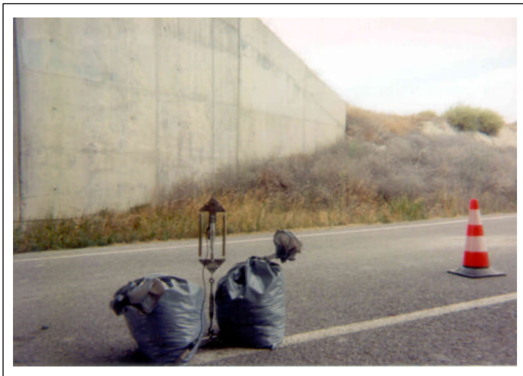
FOTOGRAFÍA 7: Transductor de desplazamiento en centro de vano
