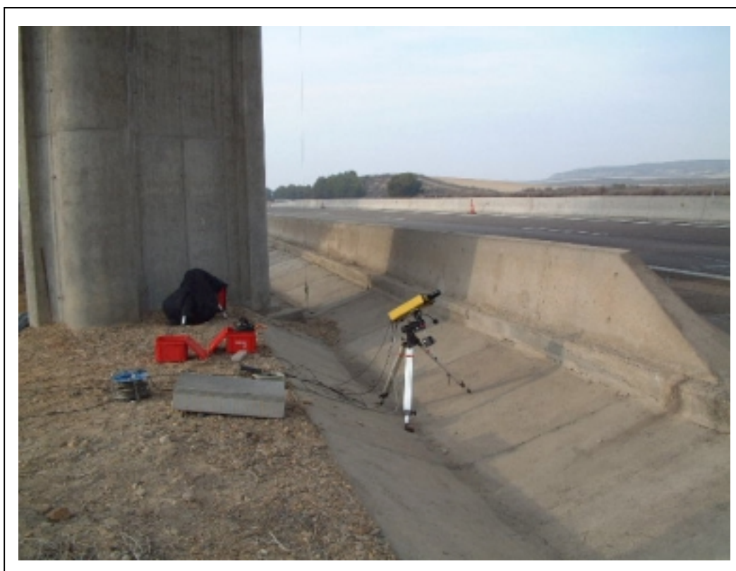
FOTOGRAFÍA 8: Equipo láser para medida de flechas
