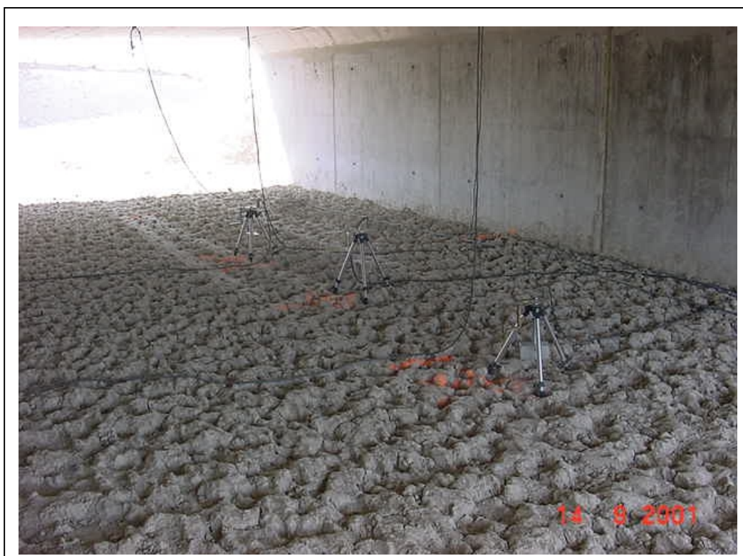
FOTOGRAFÍA 6: Transductores de desplazamiento tipo ménsula
