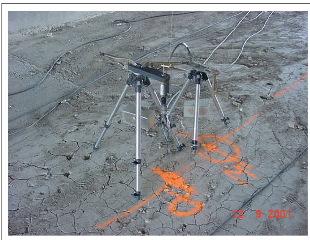
FOTOGRAFÍA 6: Transductores de desplazamiento tipo ménsula
