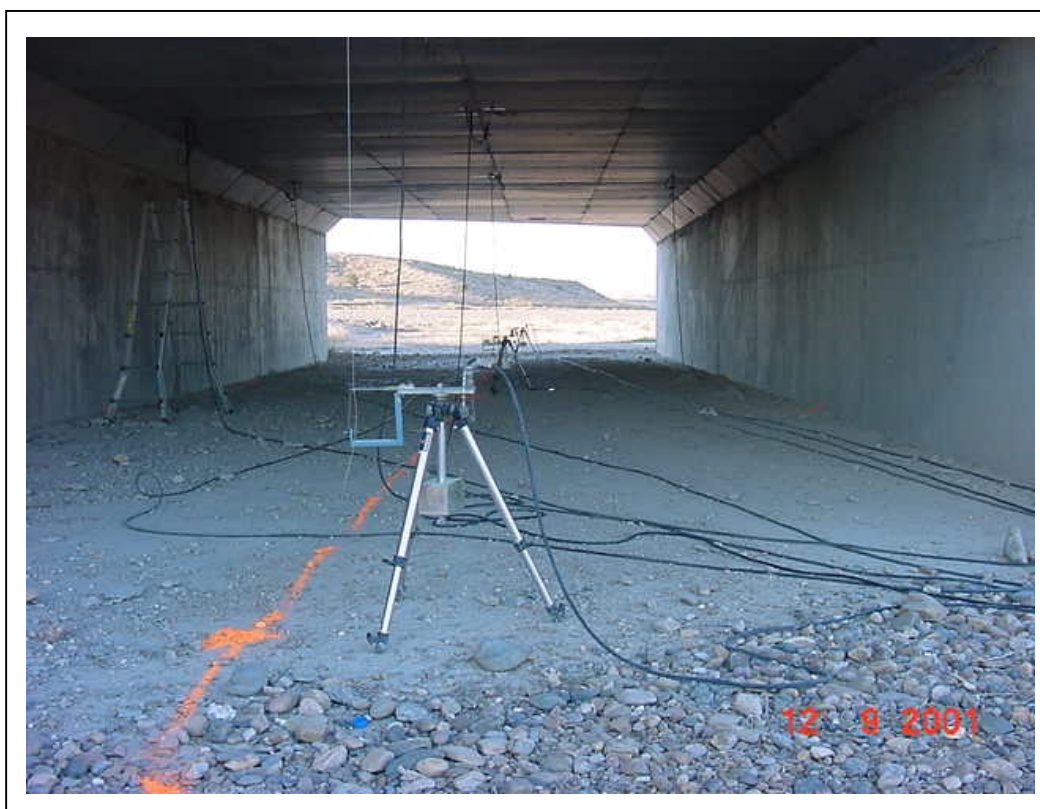
FOTOGRAFÍA 4: Instrumentación en centro de vano
