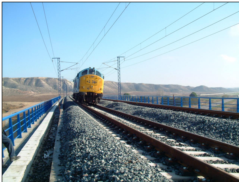
Nº 8.- Realización de las prueba dinámica lenta.
