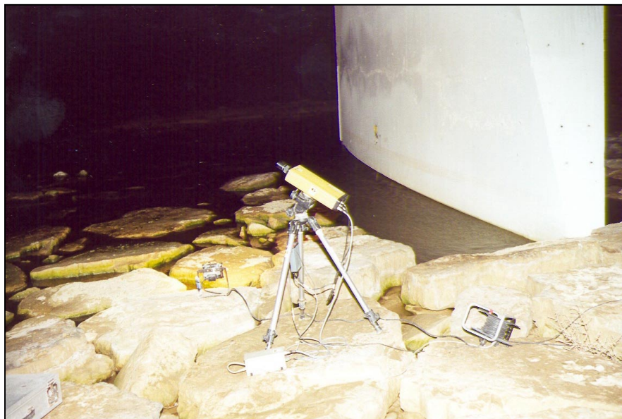
Nº 2.- Láser midiendo a cuarto de luz del vano 10.
