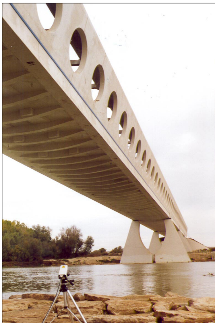
Nº 1.- Equipo láser situado en vano 10
