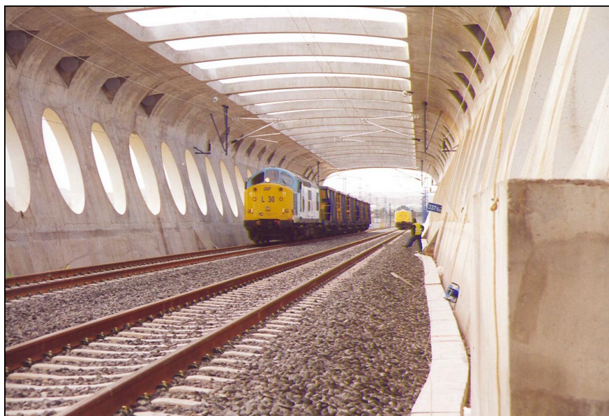
Nº 5.- Posicionamiento de cargas en vanos 8 y 9.
