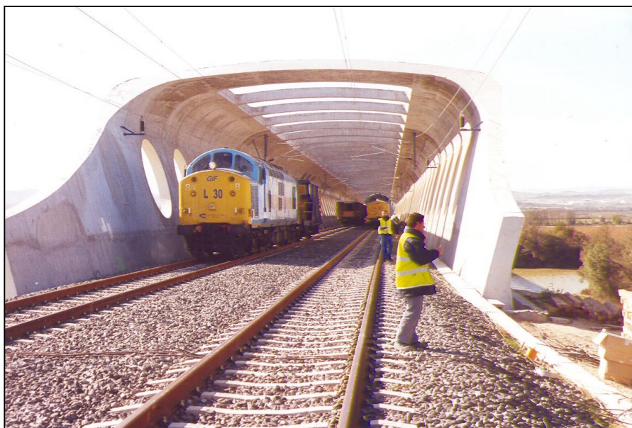
Nº 8.- Posicionamiento de cargas en vanos 11 y 13.
