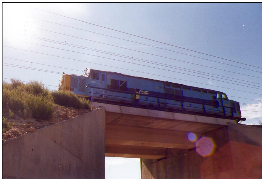
Nº 2.- Realización de las pruebas estáticas
