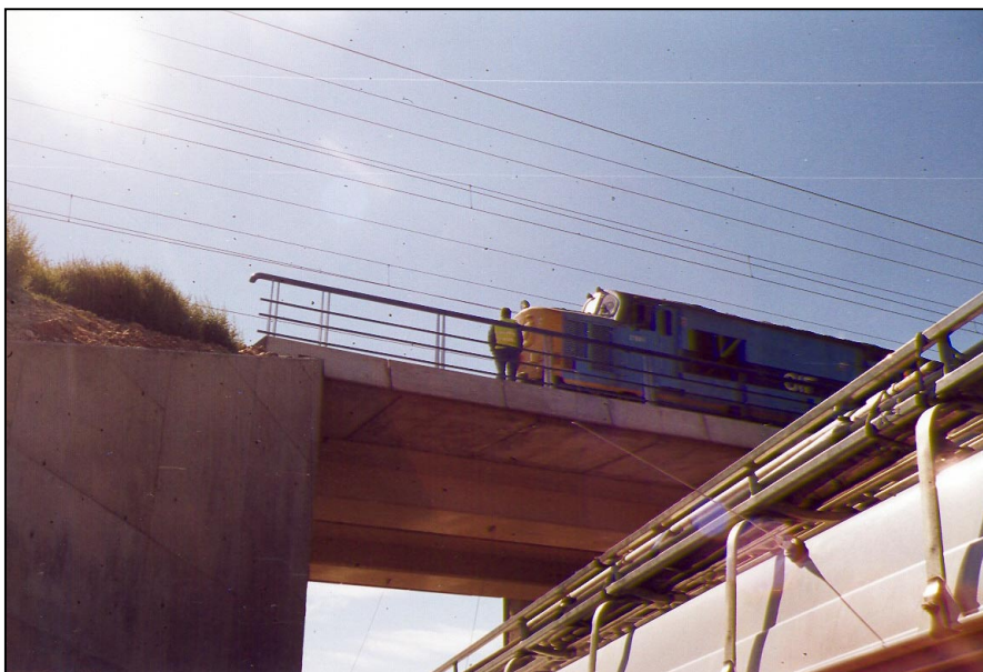
Nº 3.- Realización de las pruebas dinámicas lentas.
