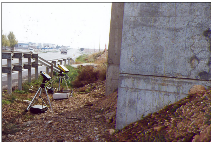
Nº 6.- Equipos ópticos utilizados para la medida de flechas en el centro de luz del vano nº 2.
