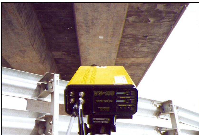
Nº 6.- Equipos ópticos utilizados para la medida de flechas en el centro de luz del vano nº 2.
