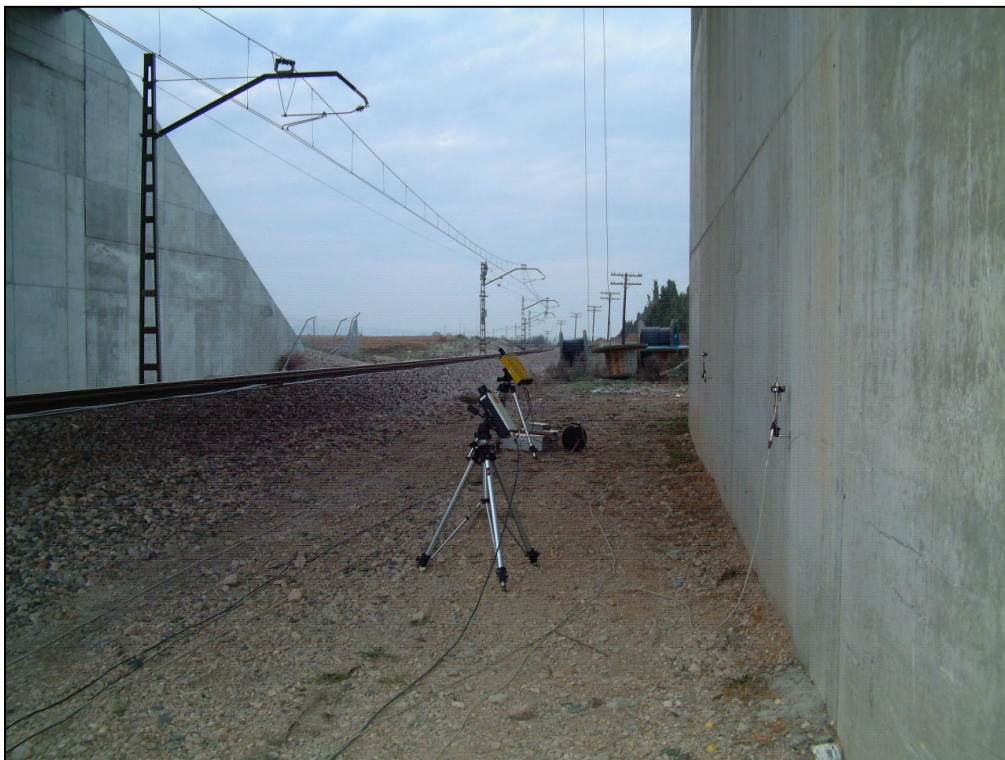
Nº 2.- Vista de los equipos láser durante la prueba
