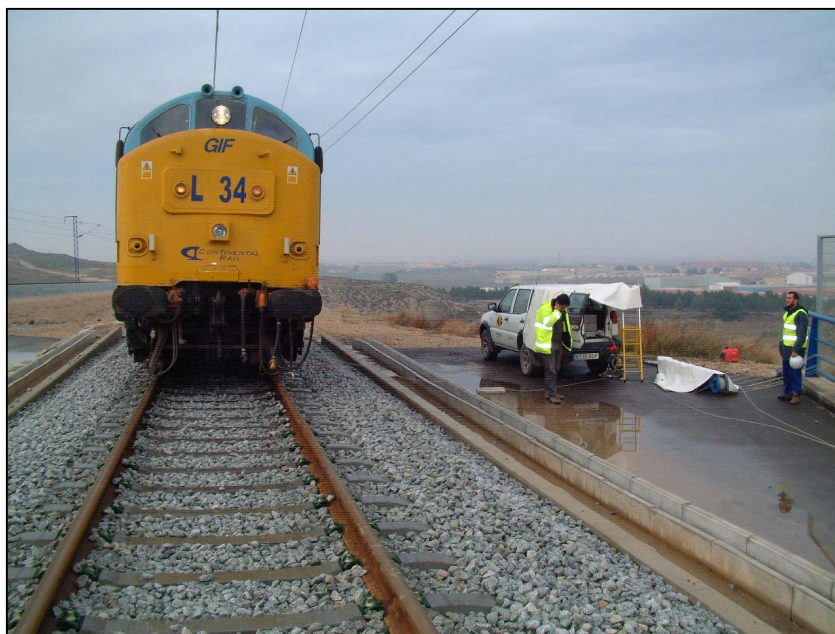
Nº 4.- Realización de la prueba dinámica a 30 Km/h.
