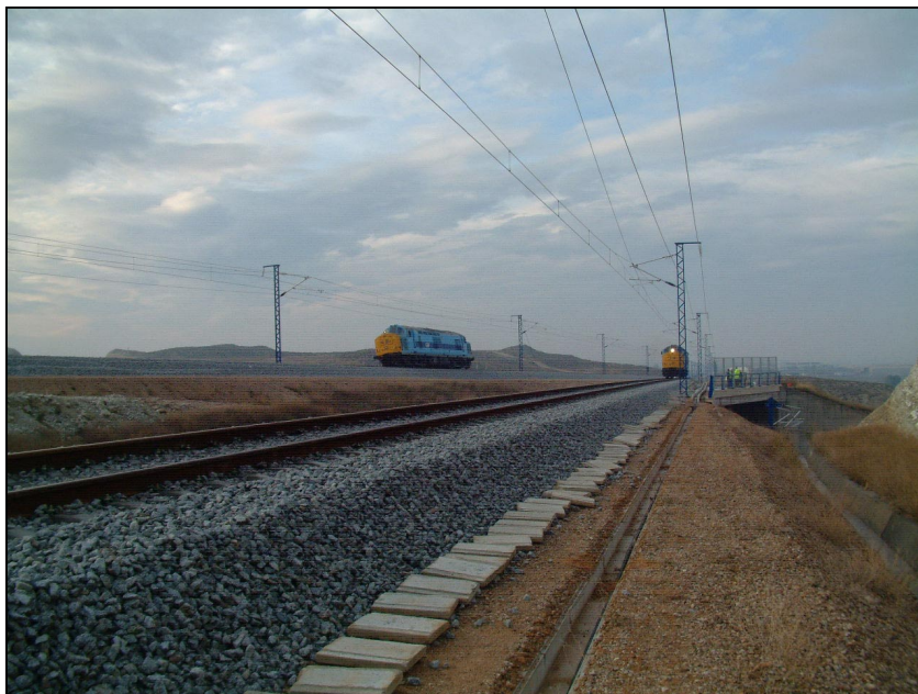
Nº 6.- Realización de la prueba dinámica de frenado
